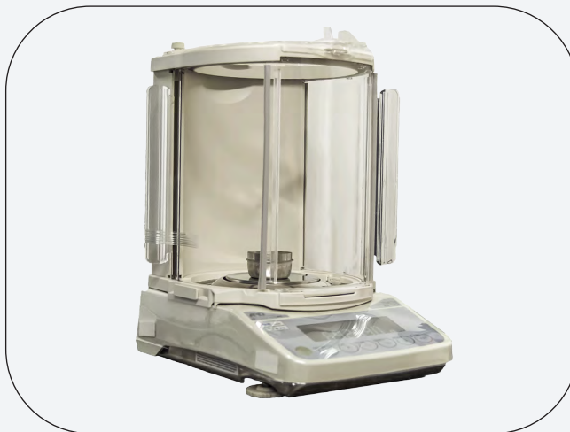
Balanza de precisión para crisoles, muestras y fundente
