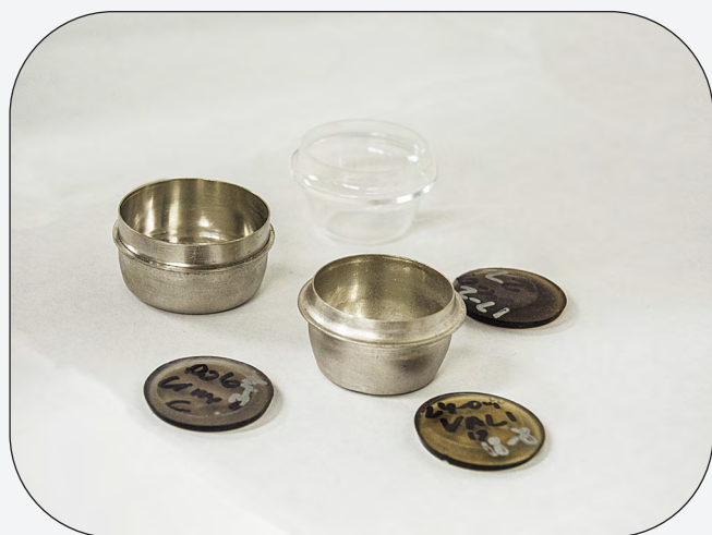
Crisoles para fusión de muestras para análisis por XRF y análisis termogravimétrico (TGA)
